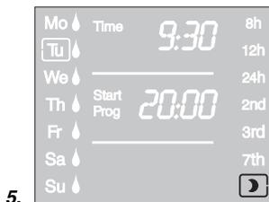
5. Sensor-Direktsteuerung mit den ▼-▲-Tasten wählen und mit der **OK**-Taste bestätigen.
