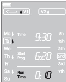
3. Während die Bewässerungsdauer-Minuten blinken, kann die Bewässerungsdauer mit den ▼-▲-Tasten (zwischen **0:00** und **0:59**) geändert (Bsp. **10 Minuten**) und mit der **OK**-Taste bestätigt werden.
